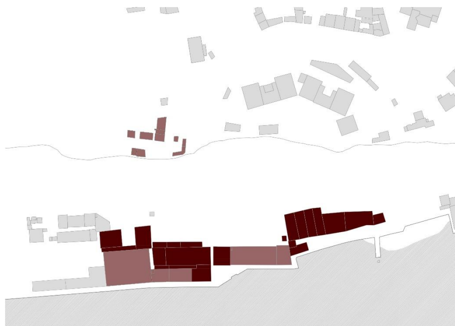
Figura 9 - Estado de conservação dos edifícios a intervir (muito mau – bordeaux, mau – bordeaux claro)
